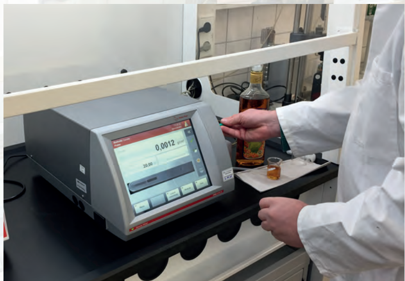
Prüfung der Dichte des Inhalts einer Fertigpackung im Prüfraum des
