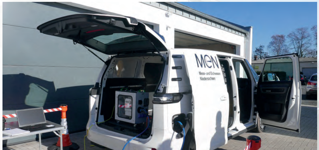
Fahrzeug mit Ausrüstung für die Eichung von E-Ladesäulen
