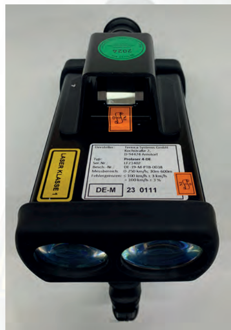
Laserhandmessgerät (Laserpistole) 2022 durch das MEN für die Polizei in Niedersachsen geprüft
