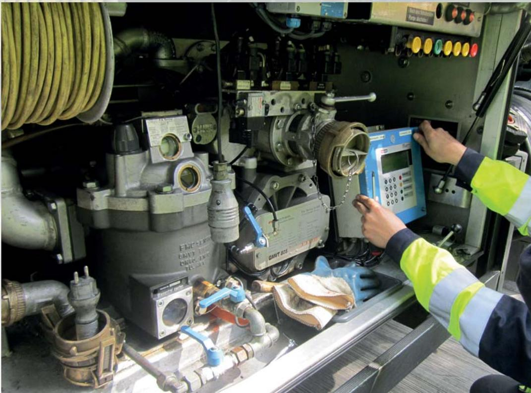
Kontrolle des Temperatur-Mengenwerters einer Messanlage auf einem Straßentankwagen
